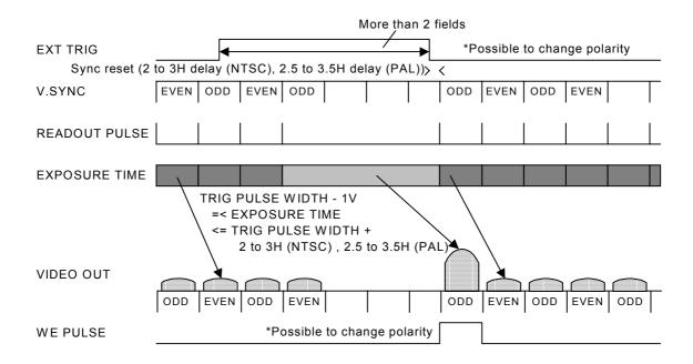
(2) Frame mode (SHUTTER: EXT TRIG, EXT TRIG: MODE1, CCD MODE: FRAME)
